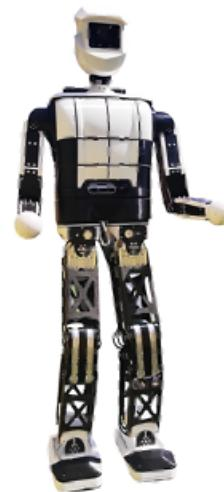
В МФТИ создали человекоподобного робота, который под управлением ИИ может работать среди людей. С помощью систем компьютерного зрения робот строит карту и ориентируется в пространстве. Он способен "встраиваться" в уже существующие планировки комплексов, не требует перестроения помещений. Робот способен взять на себя выполнение рутинных задач: поднимать тяжести, снимать товары с полок и помещать их в контейнеры.
