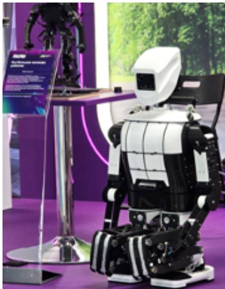
**Макет антропоморфного робота для автоматизации технологических процессов**, разработанный в МФТИ в Исследовательском центре прикладных систем искусственного интеллекта, в человеко-ориентированной среде, например выполнения типовых задач на складах и ПВЗ в автономном режиме. Робот обладает атлетическим и поведенческим интеллектом. Антропоморфность позволяет работать в человеко-ориентированной среде и выполнять манипуляции с типовыми предметами.
